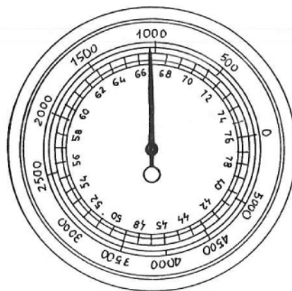
Fig. 32 - Quadrante di altimetro con le altezze da 0 a 5000 m su un'unica circonferenza. Il quadrante interno con l'indicazione della pressione barometrica è fisso, mentre quello esterno con l'indicazione dell'altezza in metri è girevole per permettere la taratura.
