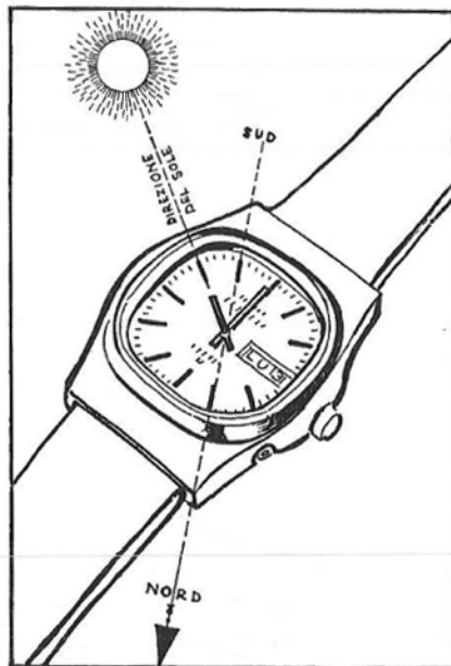
Fig. 28 - Sono le 10. Posta la lancetta delle ore in direzione del sole, nella direzione delle 5 (10:2) si avrà il Nord.
