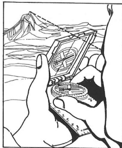
Fig. 22 - Rilevamento di un azimut per mezzo di una bussola del tipo in plastica trasparente, ma munita di un coperchio a specchio. Occorre, per leggere l'angolo, far coincidere la linea verticale presente sullo specchio con il centro dell'immagine riflessa delle bussola e, osservando l'oggetto del rilevamento attraverso la tacca esistente sulla parte alta del coperchio, girare il cerchio graduato fino a far entrare la parte N dell'ago calamitato tra le due tacche che indicano il N del cerchio graduato. In corrispondenza dell'indice fisso che si trova nella direzione di osservazione si leggerà quindi l'azimut.
