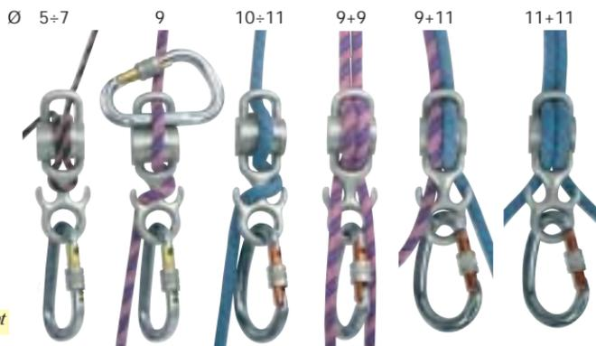
La corda si inserisce senza staccare l'attrezzo dall'imbracatura: basta infatti sollevare lo scorrevole verso l'alto e far passare le corde sopra lo scorrevole stesso che ritornerà in sede automaticamente sotto tensione. Se si impiega il robot con mezze corde, per aumentare l'effetto della frenatura è opportuno far passare le corde dentro le due sporgenze.
