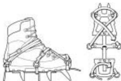
serraggio delle cinghie sullo scarpone; il secondo difetto è diretta conseguenza del primo: serrando troppo si provoca una costrizione del piede all'interno dello scarpone che può portare anche a dei congelamenti. È un sistema un po' superato e risulta più lento durante ascensioni di misto, dove è indispensabile togliere e mettere i ramponi più volte.
